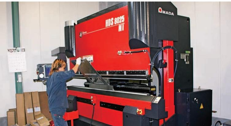
導入したばかりのベンディングマシン HDS-8025NT による曲げ加工
