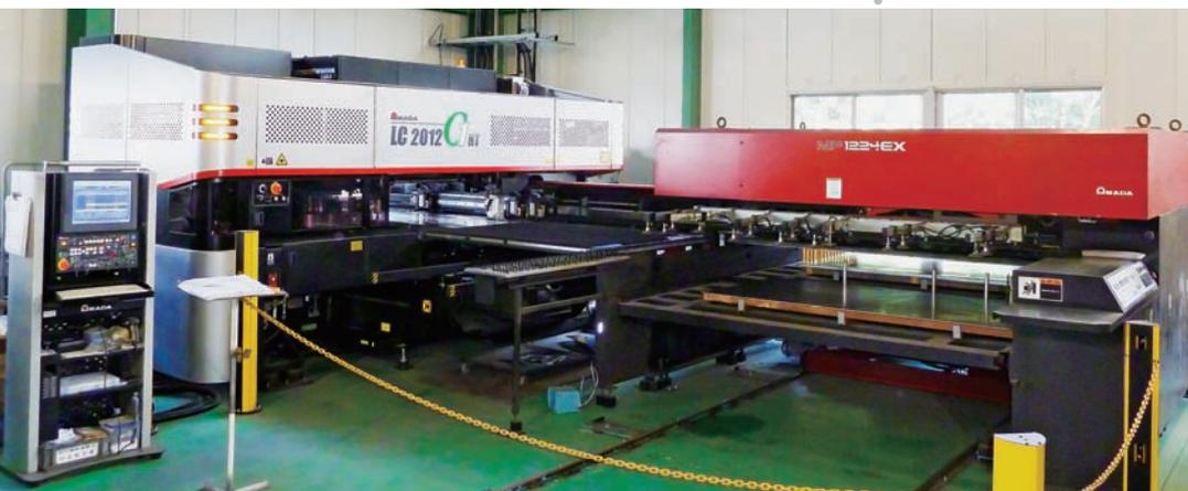
工程統合マシン LC-2012C1NT を導入したことで、バリレス加工やタップ・成形加工がワンクランプで可能となり、工数削減効果が得られた
